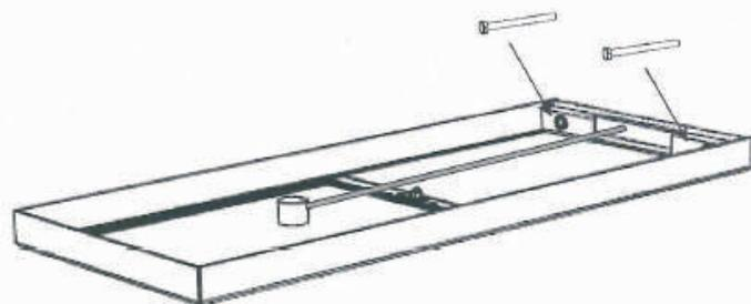
**ITA** - Dal kit di fissaggio in dotazione prendete i due bulloni e predisponeteli nei due fori della staffa posteriore del soffione utilizzando anche le due ranelle che rimarranno poi tra i bulloni e la staffa.
