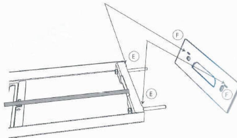
**ITA** - posizionare il rosone al corpo soffione prestando attenzione nell'inserire le 2 linguette (E) presenti sul corpo principale negli appositi alloggiamenti (F) del rosone stesso
